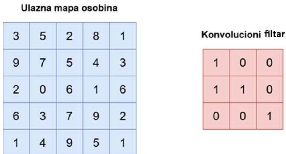
Slika 8. Lijevo: Ulazna mapa osobina dimenzije 5×5 (dubina 1). Desno: konvolucija dimenzije 3×3 (dubina 1).
